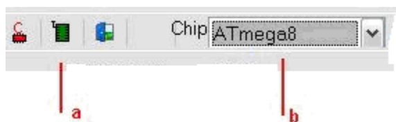
Rysunek 6. Pasek zadań programatora. Ikona a - automatyczne wgranie programu, b - rozpoznany układ atmega.
